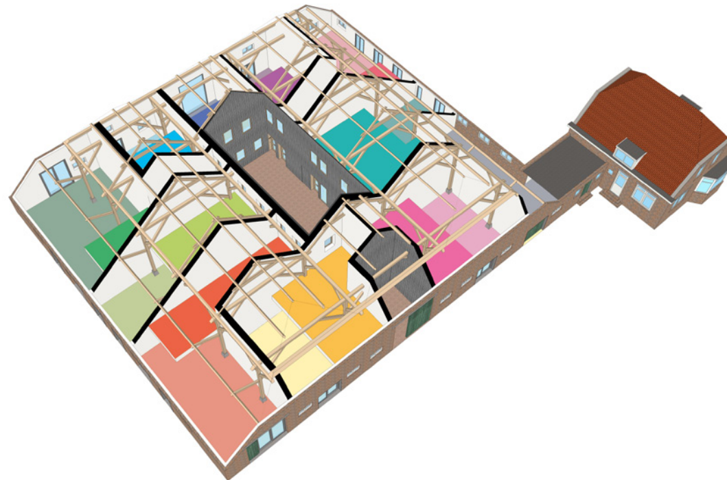
De hoevewoningen in de schuur zijn zo gepositioneerd dat de oude houten draagconstructie duidelijk in het zicht blijft
