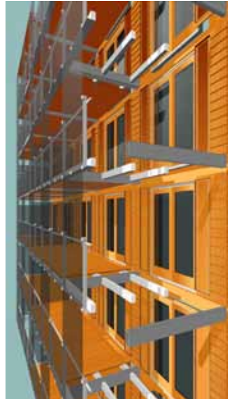
Het gebouw heeft een houten gevel met daar omheen een glazen huid
