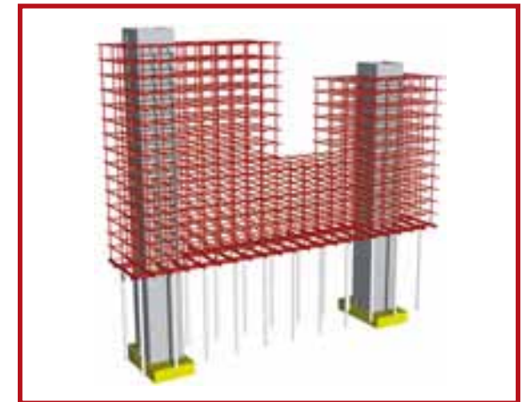
Constructie principe met grijs de twee betonnen kernen met trap en liften en in rood de staalconstructie
